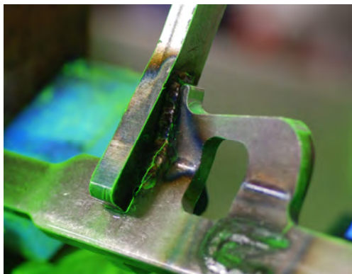
Индикация дефектов, полученная с применением флуоресцентной магнитопорошковой суспензии на водной основе Super Magna LY 1500
