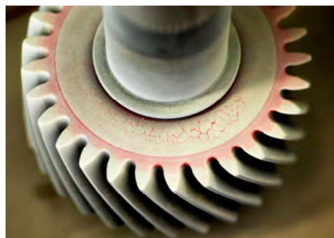
Индикация дефектов с помощью контрастной капиллярной системы
