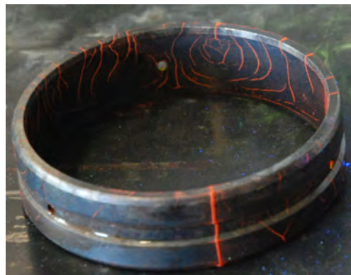
Индикация дефектов, полученная с применением красной магнитопорошковой суспензии на водной основе Super Magna MEF 515
